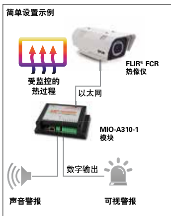
例1: 使用MIO-FCR-1实现的带报警功能的简单热监控系统
