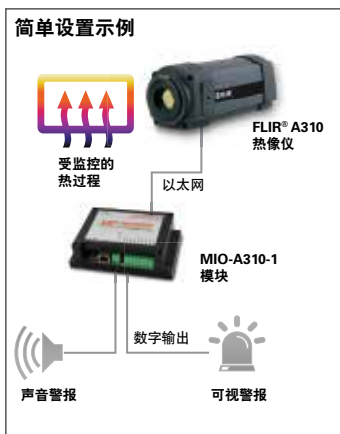
例1: 使用MIO-A310-1实现的带报警功能的简单热监控系统
